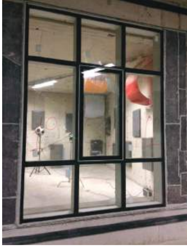
Entegre Cephe / Integrated Curtain Wall Genişlik / Width: 2150 mm Yükseklik / Height: 2820 mm
